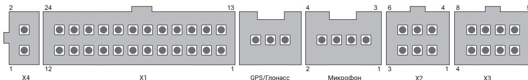
Рис. 1 Нумерация контактов в разъемах, вид со стороны проводов
